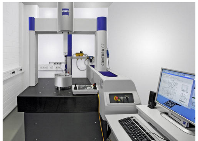
Zeiss Contura G2 Koordinatenmessmaschine mit 5 Achsen
